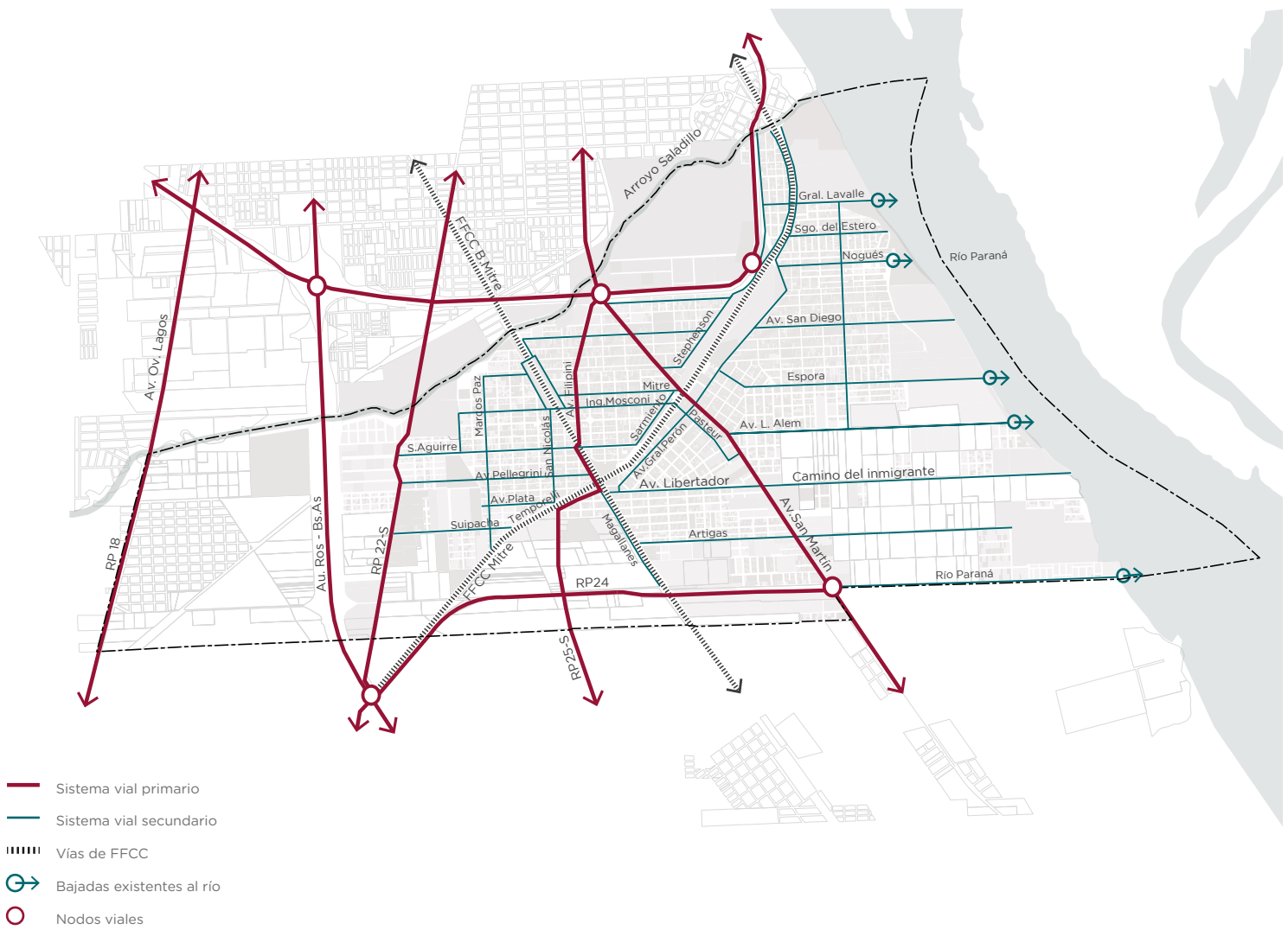
Plano 4. Sistema Vial Jerárquico y Ferroviario
